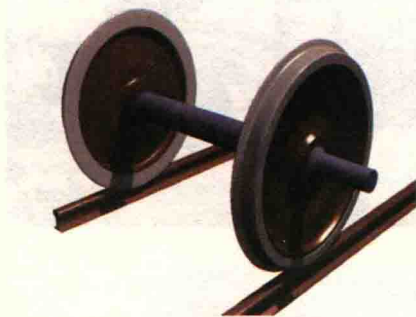
▲ 内轮缘凸出的铁路轮对
