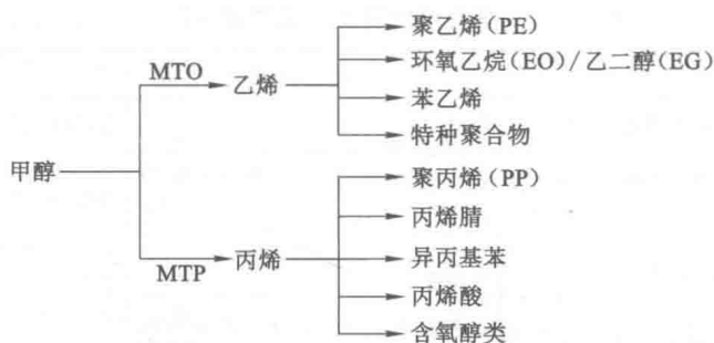
图 1-4 甲醇经烯烃制备化学品及聚合物的主要路线图
