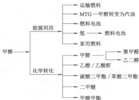
图 1-5 甲醇能源利用和化学转化主要产品路线图
