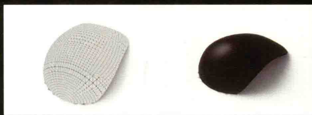
实战名称 实战——利用网格曲面创建圆顶面 技术掌握 掌握创建网格曲面的方法 难易指数 ★★★☆☆ 所在页码 199
