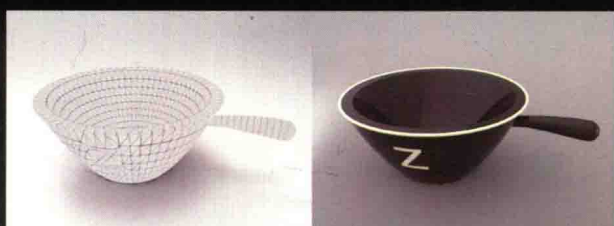
实战名称 实战——利用布尔运算制作杯子 技术掌握 掌握通过标准体制作复杂形体的方法和对实体模型进行布尔运算的方法 难易指数 ★★★☆☆ 所在页码 279
