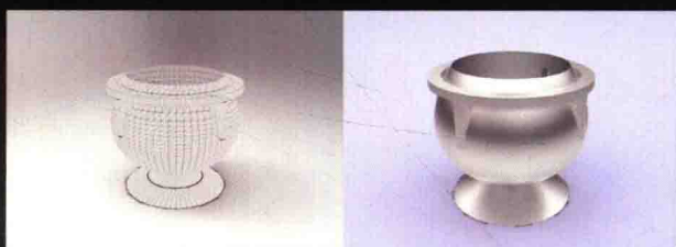
实战名称 实战——通过建立洞创建汤锅 技术掌握 掌握建立内凹洞和凸洞的方法 难易指数 ★★☆☆☆ 所在页码 306
