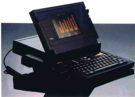
图1-7 第一台贝壳式笔记本电脑gird compass
