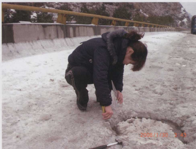
2008年1月30日，玉屏县气象局观测员在玉三高速公路上测量道路结冰厚度。冰冻灾期间，我省中东部地区道路结冰最高达200毫米以上
