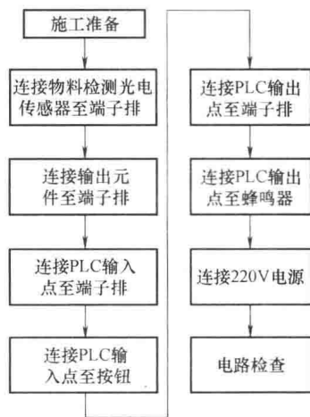
图 1-15 电路连接流程图
