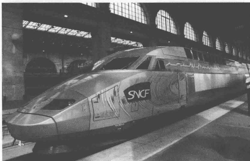
图 1-2 法国高速综合检测车—IRIS320
