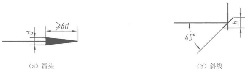
图 1-13 尺寸线的终端
