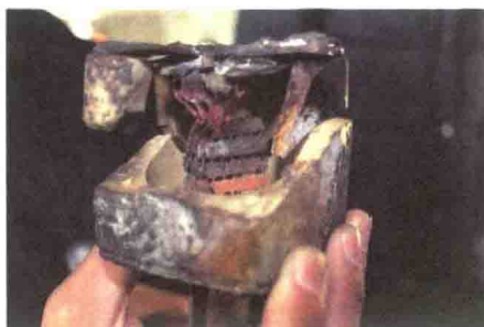
图 12 C 相熔断器内部情况
