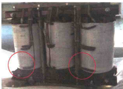
图 5 A、B 两相绕组与底部金属夹件之间垫块滑脱
