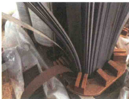
图 9 其他厂家生产的变压器垫块固定方式
