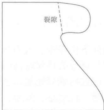
图 1-1 拉裂式崩塌破坏
