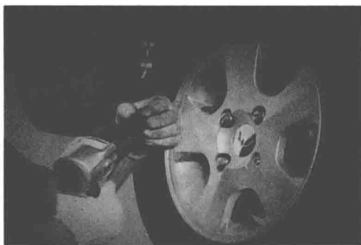
图 1-1-15 气动冲击扳手的套筒安装
