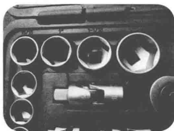
图 1-1-3 薄壁、浅腔套筒
