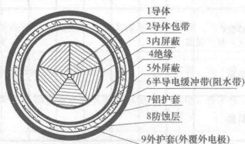
交联聚乙烯电力电缆结构截面图
