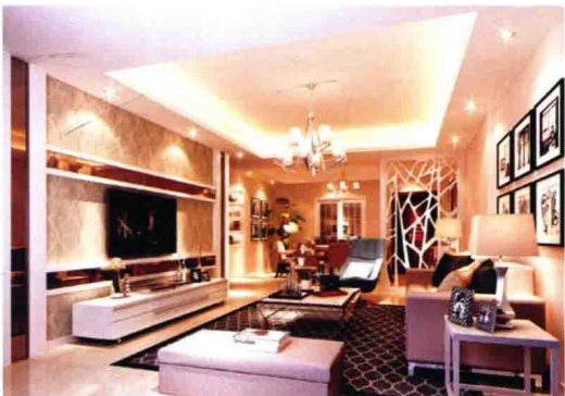
电视墙 [ 墙纸 + 茶镜 + 木线条收口 ]
