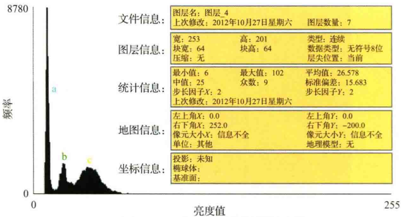
c) Landsat TM第4波段采集的原始直方图
