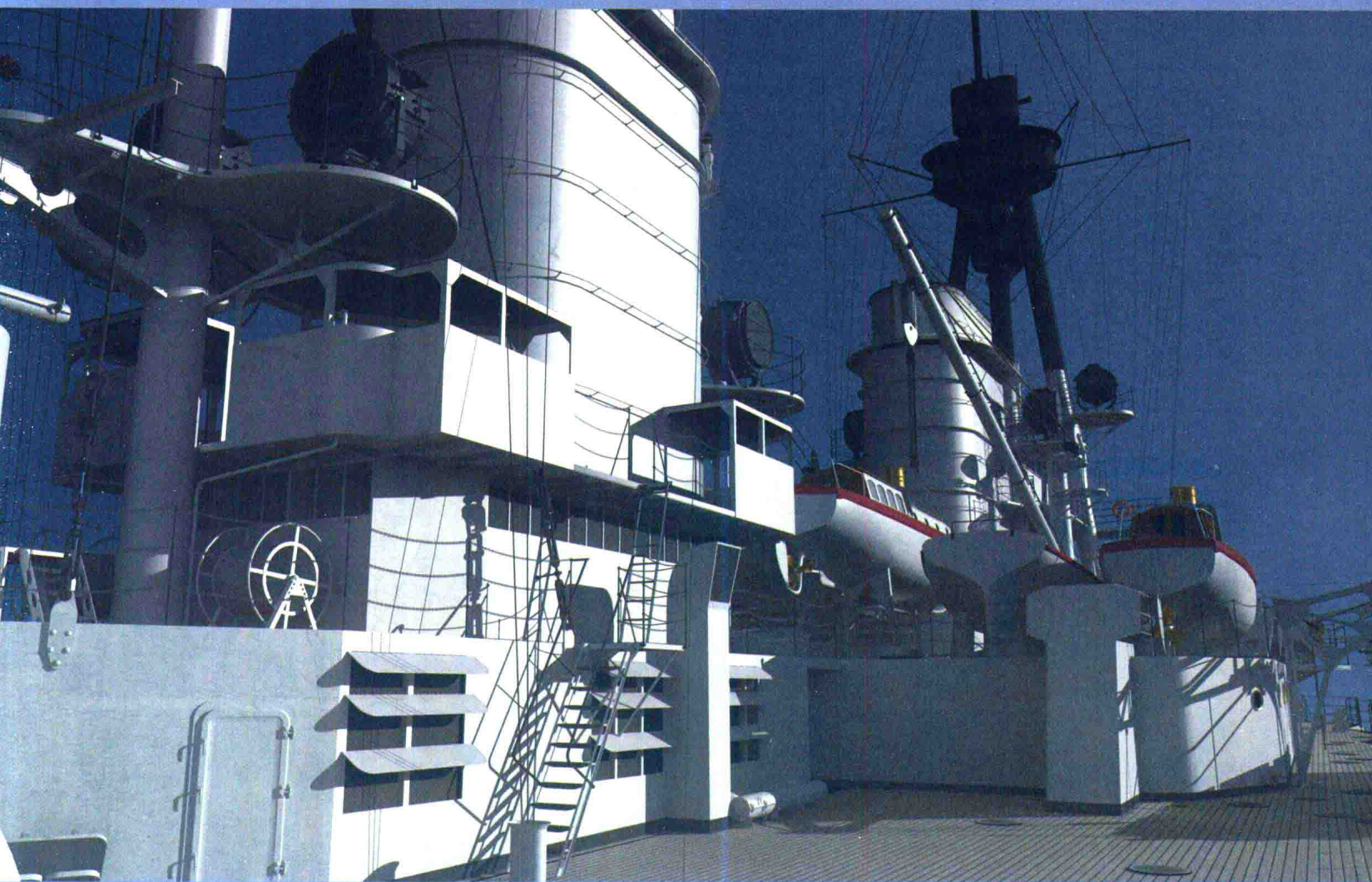
上图：“兴登堡”号的烟囱、上层建筑和前桅杆与姊妹舰“德弗林格尔”号和“吕佐夫”号不同。烟囱盖更高一些。简单的附件中包含了鱼雷瞄准装置，可以在舰艏烟囱周围看到，前桅杆从一开始就是三脚架结构。由于还存在很多细微差别，因此很容易将这些战舰区分开来。（由马斯登·塞缪尔供图）
