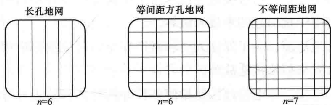
图 1-1 变电站接地网水平接地网示意图
