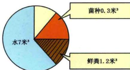
(2) 加水封池：原料和接种物入池后，要及时加水封池。现有水压式沼气池以料液量约占沼气池总容积的90%为宜，然后将池盖密封。加入沼气池的水可依次选用沼气发酵液、生活污水、河水或坑塘污水等，也可使用井水或自来水，但不得使用含有毒性物质的工业废水。
