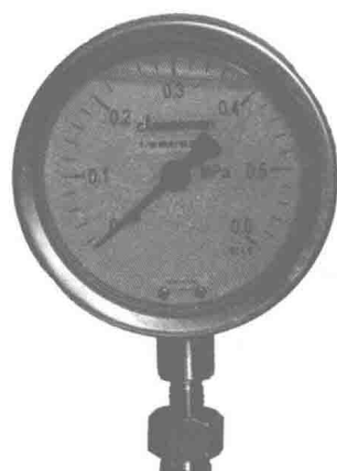
图 1.1.11 弹簧管式压力表实物图
