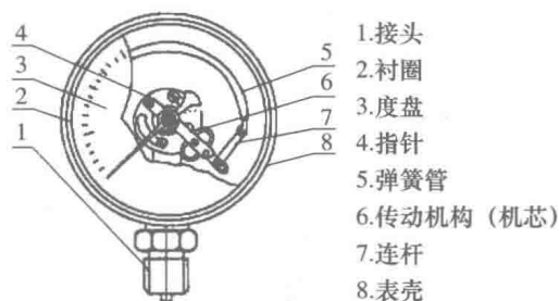
图 1.1.12 弹簧管式压力表结构图
