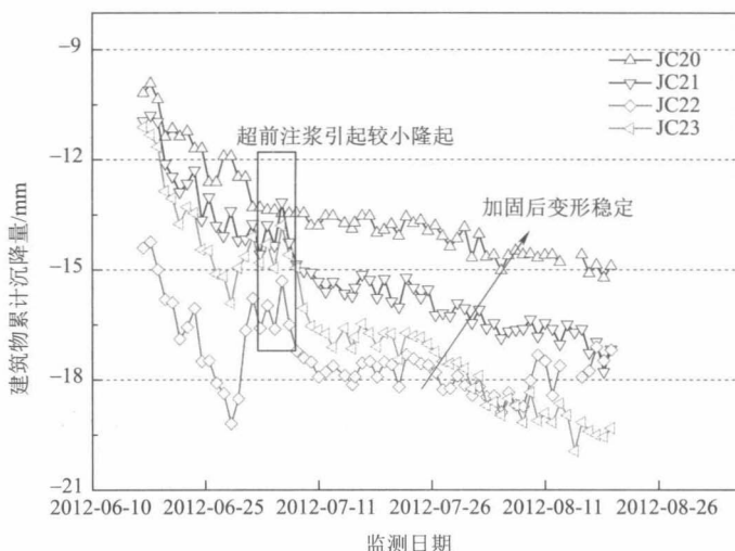
图 7 注浆加固后建筑物的累计沉降曲线
