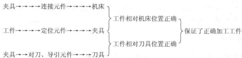
图 1-8 机床夹具工作原理
