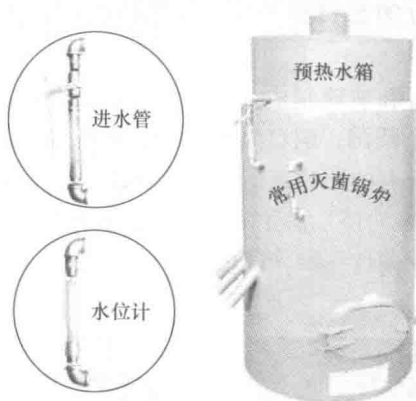
图 2-11 蒸汽发生装置示意图
