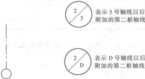
图 1-12 通用详图的轴线标法
