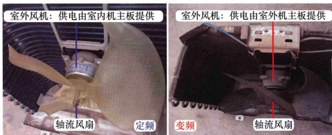
图 1-11 室外机通风系统对比
