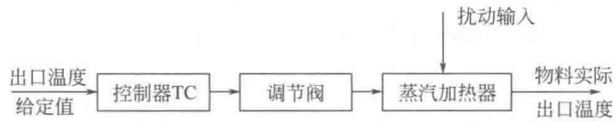
(a) 蒸汽加热器的控制方案一方块图
