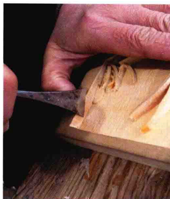
图 1-2-2 切边线——切横头
