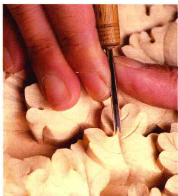
图 1-2-18 修光细饰——锐用三角凿钎出三角形的线条。
