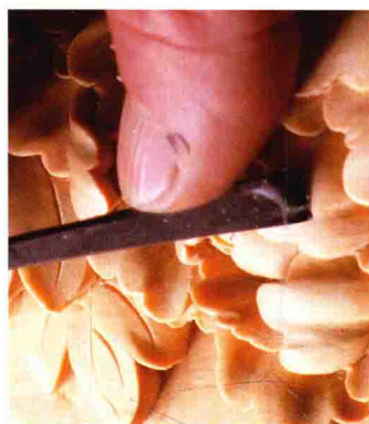
图 1-2-15 修光——正面平面用凿
