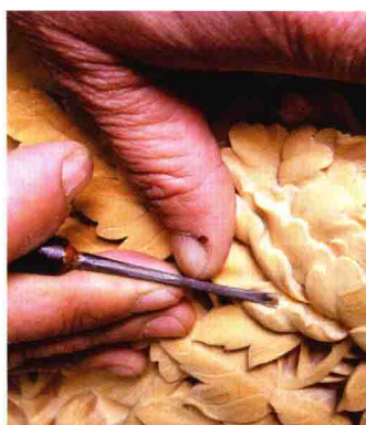
图 1-2-16 修光——侧面、底面、背面用凿
