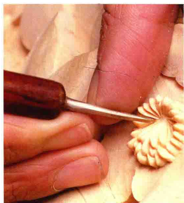
图 1-2-17 修光细饰——刻用较小的凿或斜口雕刀刻细线或细孔,用于花蕊、叶筋等细部和线条的雕刻。
