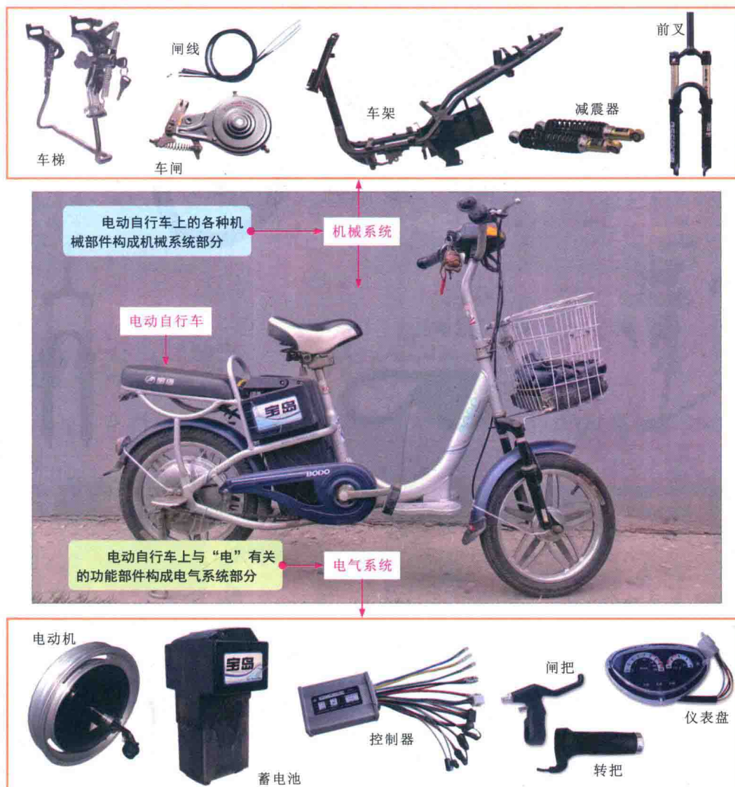
图1-1 电动自行车的整机结构
