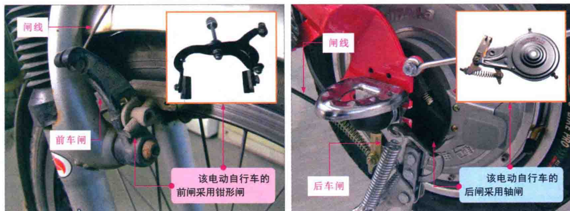
图1-4 电动自行车制动部分的结构
