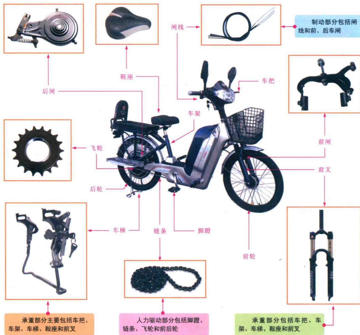
图1-2 电动自行车机械系统的组成
