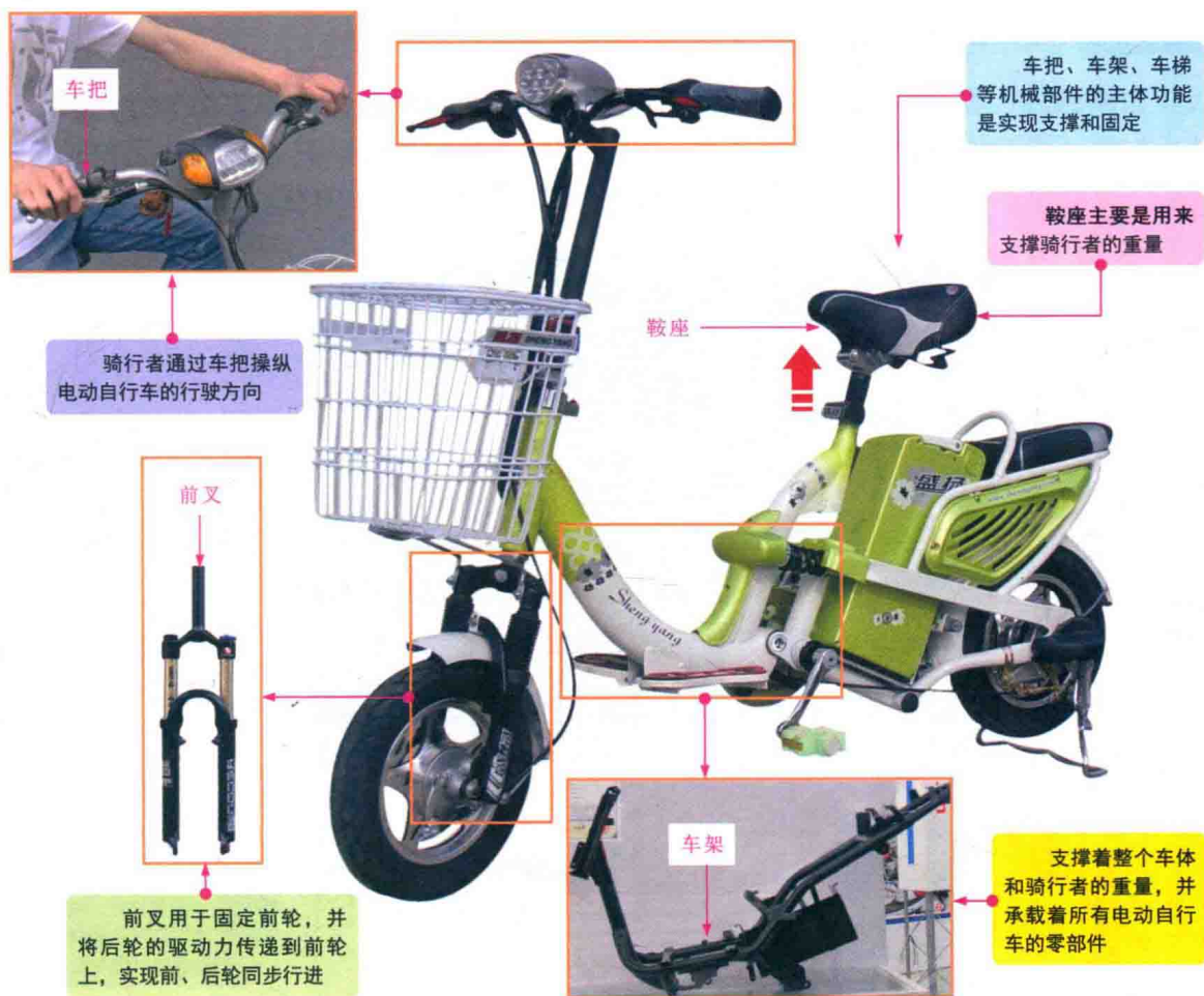
图1-3 电动自行车承重部分的结构
