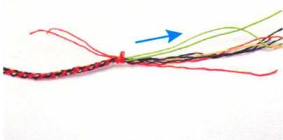
拉出绿色引出线，将红色线从线圈里拉出，拉紧固定。
