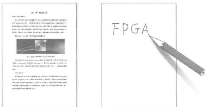
图 1.2 ASIC/ASSP 和 FPGA 就如同印刷品和白纸
