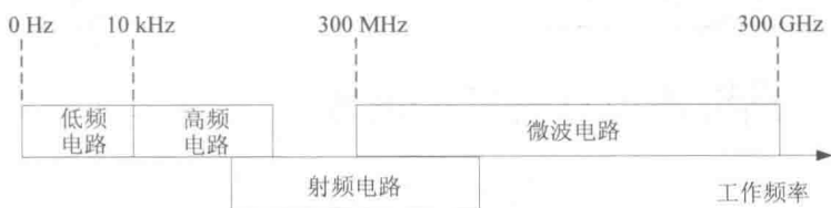
图 1.1 高频电路、射频电路、微波电路工作频率之间的关系
