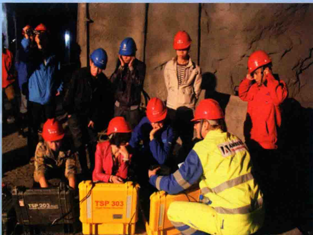
隧洞超前预报 TSP203 与 TSP303 对比现场试验
