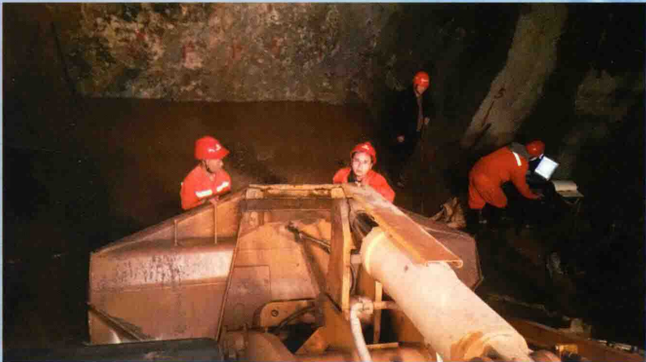
输水隧洞涌水洞段地质雷达现场测试
