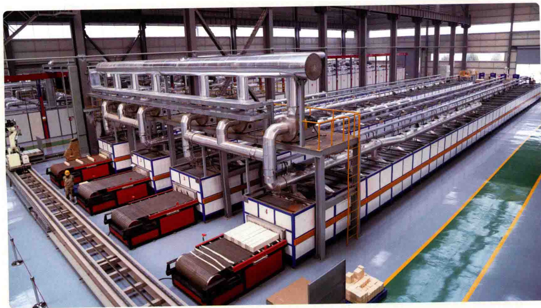
稀土基 SCR 烟气脱硝催化剂生产线
