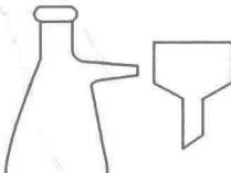
吸滤瓶和布氏漏斗                                                                                     | 两者配套使用, 用于沉淀的减压过滤 | 滤纸要略小于布氏漏斗内径; 抽气管断开后才能停泵, 防止水倒流; 不能直接加热 |
