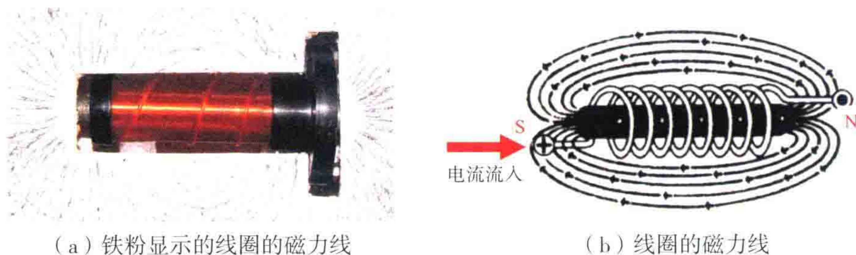
图1-21 线圈产生的磁力线
