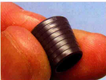
▲用水口钳将水口剪成凸起状之后，再用笔刀进行处理，将表面一点点地削薄。切割完成之后，依然还剩下了一小部分，此部分推荐用砂纸进行打磨。
