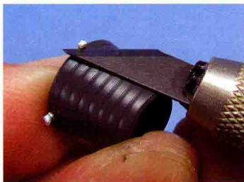
▲在用笔刀进行整形时，虽然直接将剩余的水口从根部进行切割，但若用力过猛的话是十分危险的。一定不能用力过猛，要不然一不小心可能会伤到自己。注意不要胡乱切割零件，需用各种工具一点点地进行分别加工。
