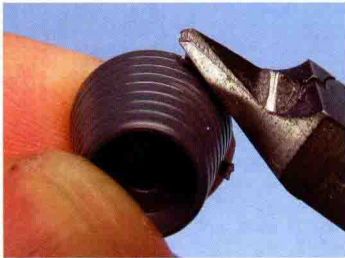
▲先不按竖直方向剪口水口中央部位，在尖端(中央)部位按斜向进行切割。先切下水口的一侧后，注意不能用刀进行切割。
