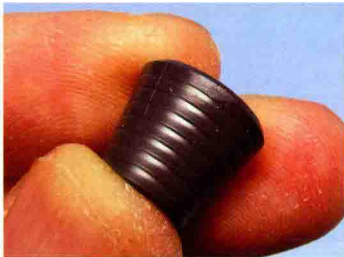
▲用打磨工具将剩下的少许水口部分小心磨去。之后不能使用质地较硬的打磨棒，使用海绵打磨工具进行表面处理。
