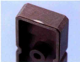
▲在SSP硬化之后，使用笔刀进行修整，再使用砂纸打磨平整之后就完成了。修整零件上被切坏的部分有些困难，操作时需要十分谨慎。
