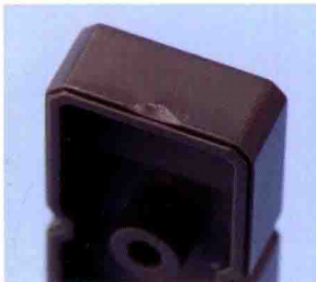
▲若是用力过度不小心把零件切坏了。可以看到图中的零件被切凹了一大块。在这里必须要进行修补。
