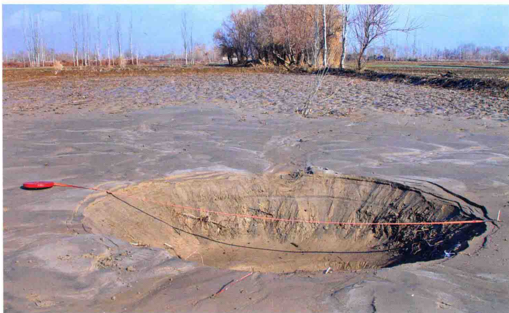
图 1-4-4 最大的喷砂孔直径 3m
