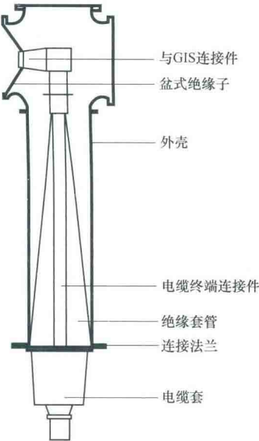
图 1-18 电缆终端与 GIS 连接结构示意图
