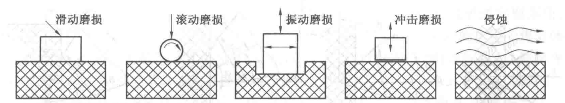
图 1.14 刀具与煤岩不同相对运动的磨损形式
