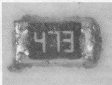
图 1.14 贴片电阻引出脚银被腐蚀
