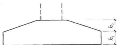
图 1-3 坡形截面普通独立基础竖向尺寸
