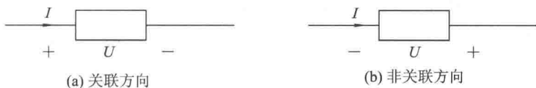
图 1.12 电流、电压的关联与非关联参考方向
