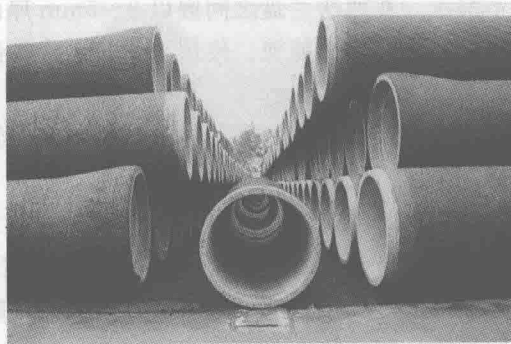
(b) 预应力钢筒混凝土管
