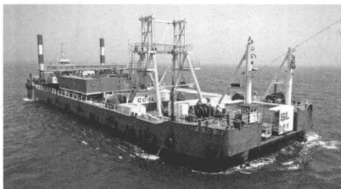
图 1-2-3 海洋钻机模块拆分装运
