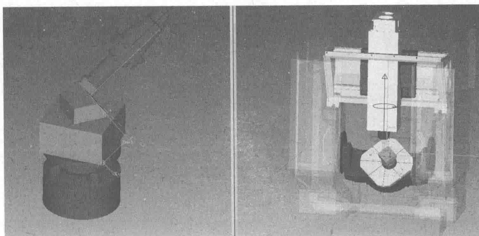
图 1-6 HERMLE_C30 五轴双转台加工中心
