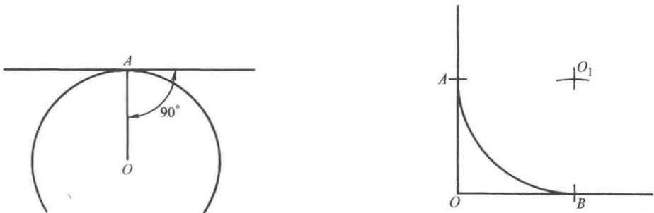
图 1-22 过圆弧上定点划圆弧切线
