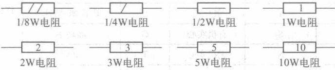
图 1-3 电阻器额定功率的符号表示
