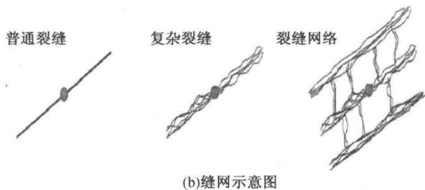
图 1-3 体积压裂改造原理图
