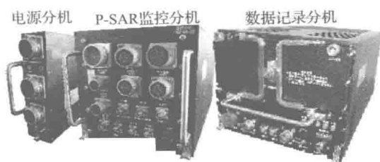
图 8.12 电源分机、P-SAR 监控分机和数据记录分机
