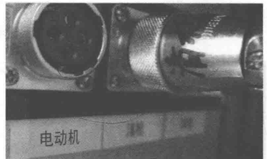
图 1-18 电动机、清枪器和焊机的连线
