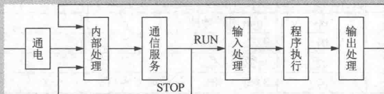
图 1-5 PLC 的工作过程
