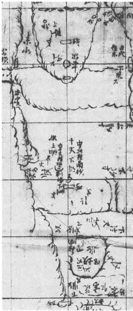
图2 上图局部，可见由穴中“出平”即作为平格网的原点，中轴线上的小方块表示线墩，其间距为2格，即10丈
