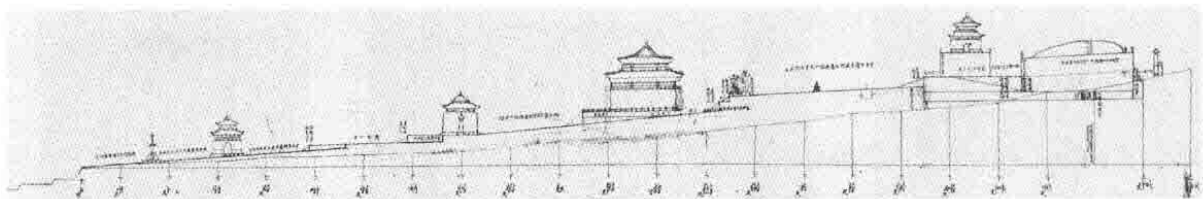
图4 咸丰八年九月《平安峪中路平子样糙底》(251-1),由中轴线高程数据生成地形断面,所用数据与图1的记录相同。在此基础上绘制的竖向设计图,其地宫尚为四道券,布局与上图基本相同,但明显缩减了隆恩门前大月台进深,对平面方案中主体建筑松散、前段空间严重不足的问题作了一定的纠正;但竖向布局太过平缓,尚不能贴合实际地形
